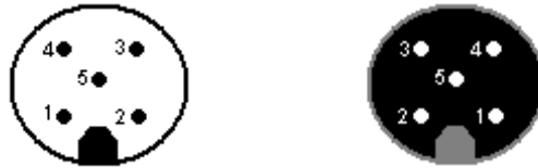
Abbildung 5: Pinbelegung: Einbaustecker / Kupplung für 5-Pol
