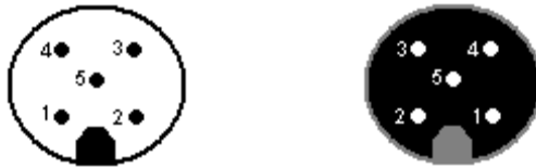
Abbildung 5: Pinbelegung: Einbaustecker / Kupplung für 5-Pol
