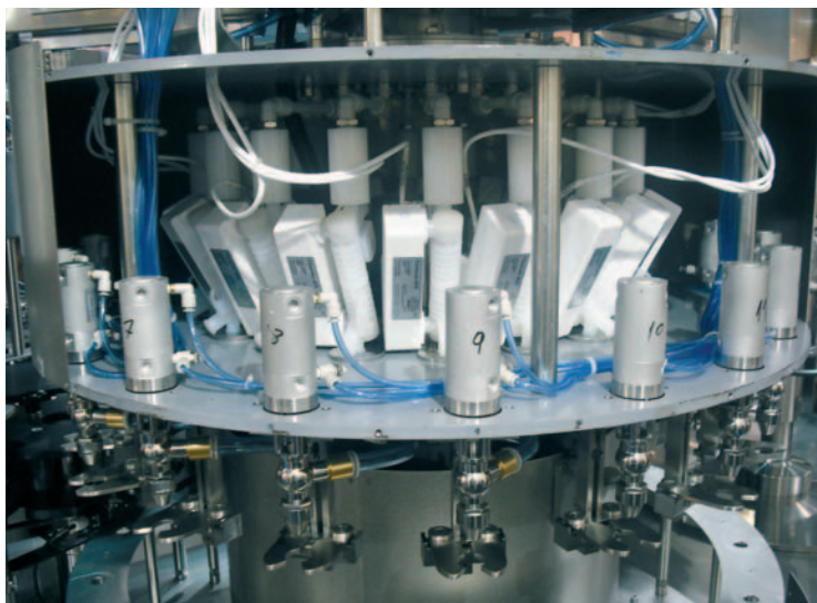
Das Messsystem dosiert Zusatzstoffe wie Vitamine oder Aromen millilitergenau zu und stellt somit die Qualität der Getränke sicher.
